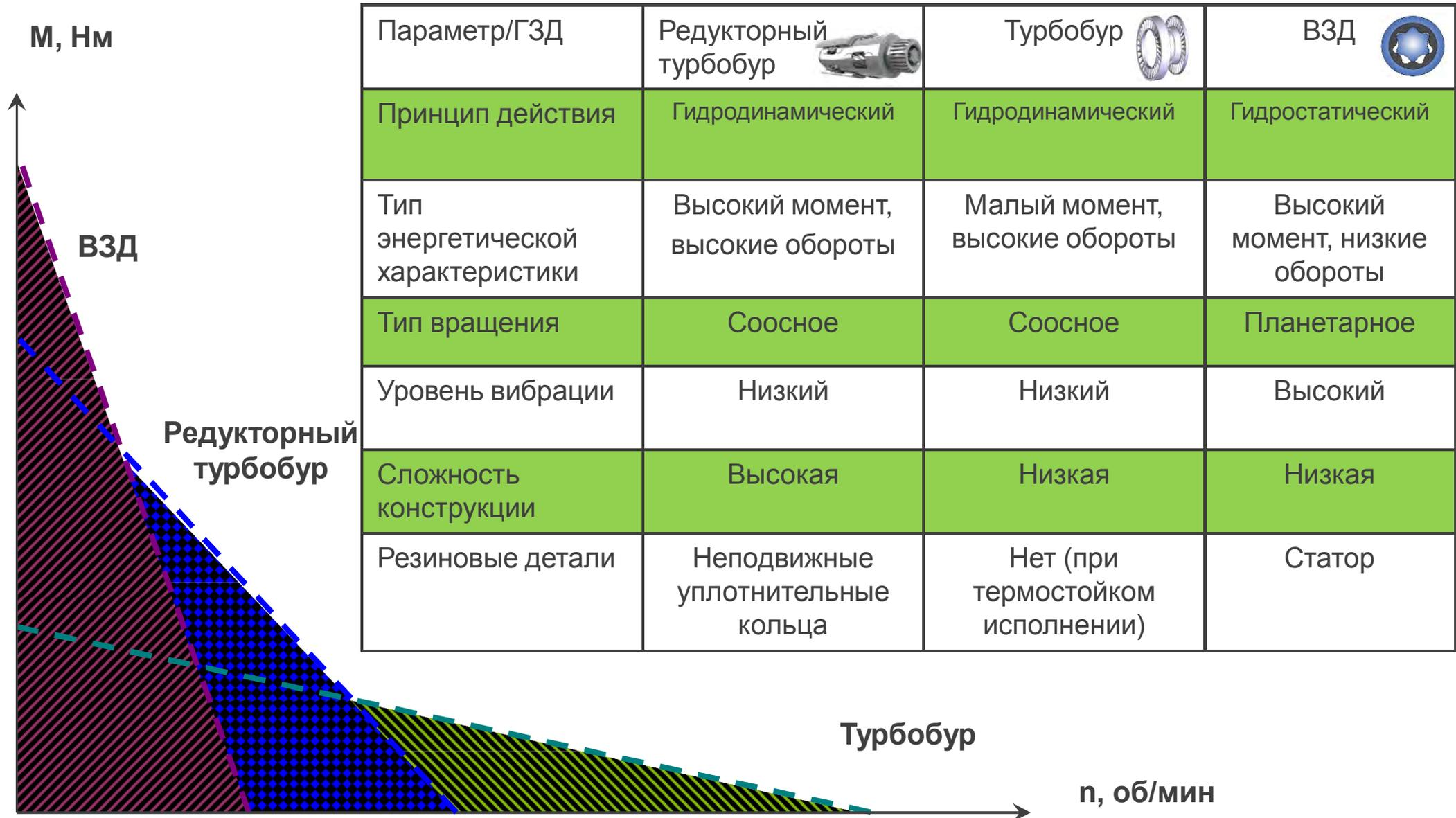
Винтовые забойные двигатели предназначены для работы с буровыми растворами с содержанием песка до 1%, при забойной температуре не более 120°C в стандартном исполнении и не более 160°C в термостойком исполнении.
