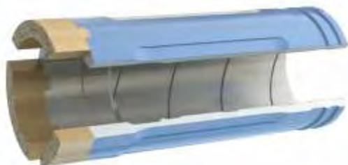
Фрезеры истирающие-режущие кольцевые типа ФК предназначены для фрезерования прихваченных бурильных и насосно-компрессорных труб в обсаженных скважинах. Фрезеры изготавливаются как левого, так и правого вращения. Фрезер состоит из цилиндрического корпуса, нижняя часть которого армирована композиционным материалом из дробленного твердого сплава. По желанию заказчика могут изготавливаться различные типоразмеры ФК. При заказе указывается: шифр изделия, присоединительная резьба.
