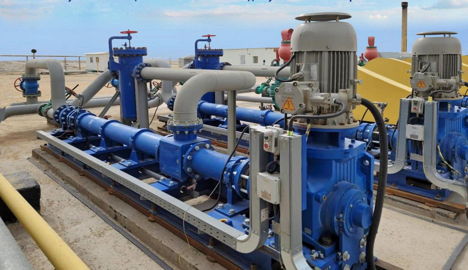
Установки в стандартном исполнении комплектуются кранами слива и обратными клапанами, по запросу предохранительными клапанами.
