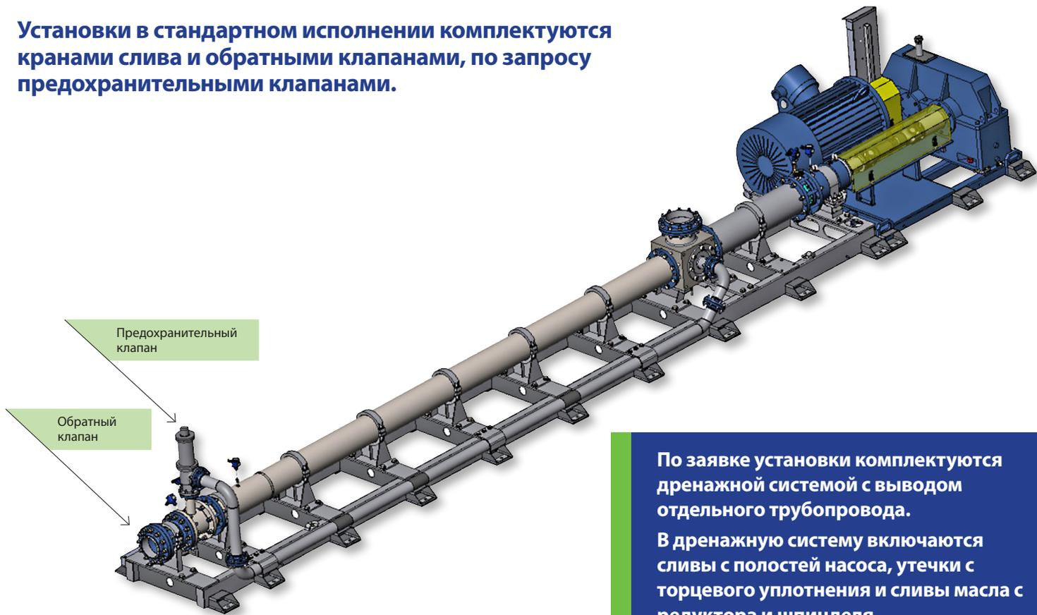
По заявке установки комплектуются дренажной системой с выводом отдельного трубопровода. В дренажную систему включаются сливы с полостей насоса, утечки с торцевого уплотнения и сливы масла с редуктора и шпинделя.
