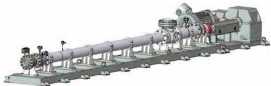
**Общий вид мультифазной насосной установки**
