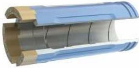
Фрезеры истирающие-режущие кольцевые типа ФК предназначены для фрезерования прихваченных бурильных и насосно-компрессорных труб в обсаженных скважинах. Фрезеры изготавливаются как левого, так и правого вращения. Фрезер состоит из цилиндрического корпуса, нижняя часть которого армирована композиционным материалом из дробленного твердого сплава. По желанию заказчика могут изготавливаться различные типоразмеры ФК. При заказе указывается: шифр изделия, присоединительная резьба.
